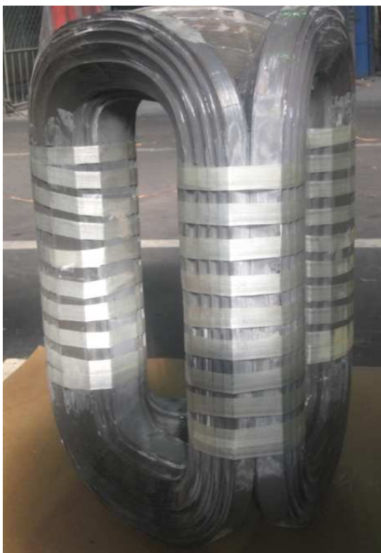
Stezač za dovodjenje stuba jezgra u idealni krug pre lakiranja ili žarenja jezgra radi stabilizacije delta oblika
