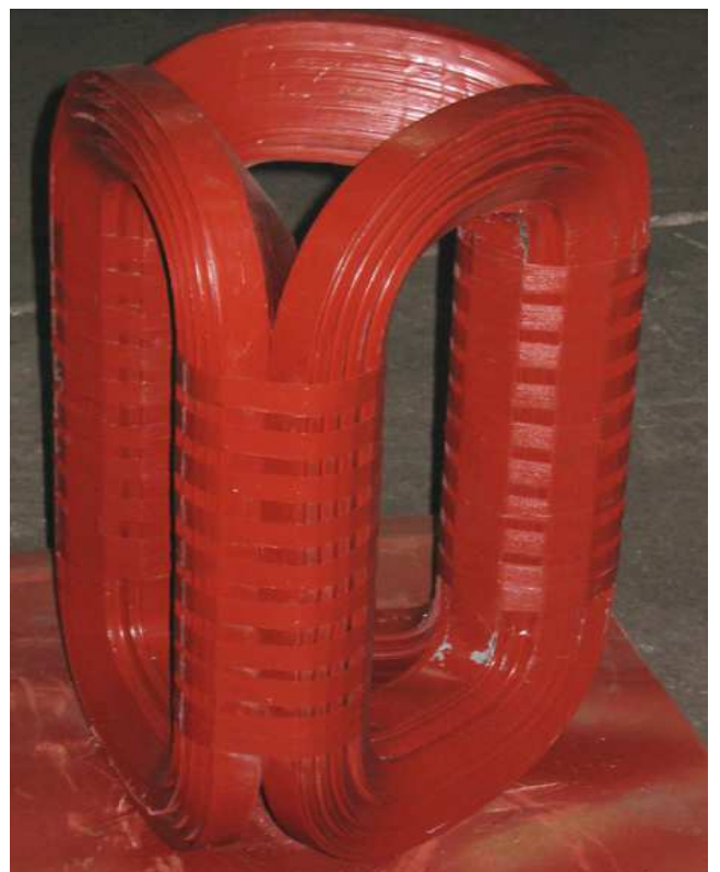
Stezač za dovodjenje stuba jezgra u idealni krug pre lakiranja ili žarenja jezgra radi stabilizacije delta oblika
