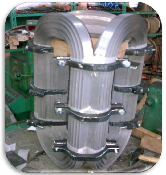
Stezač za dovodjenje stuba jezgra u idealni krug pre lakiranja ili žarenja jezgra radi stabilizacije delta oblika
