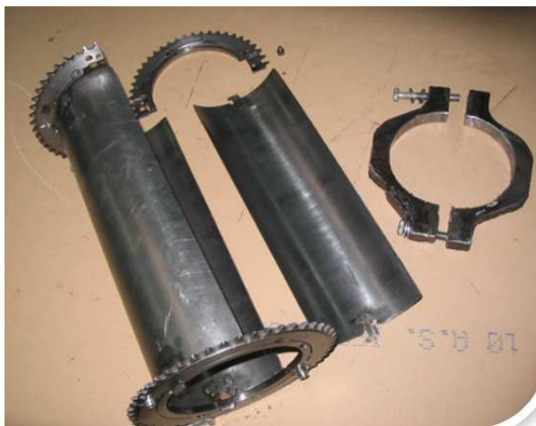
Fiksiranje idealnog kruga jezgra i lakiranje radi stabilizacije oblika
