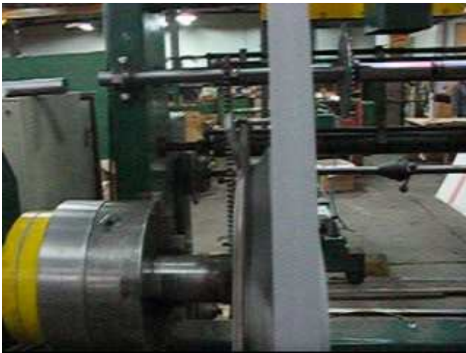
Fiksiranje idealnog kruga jezgra i lakiranje radi stabilizacije oblika
